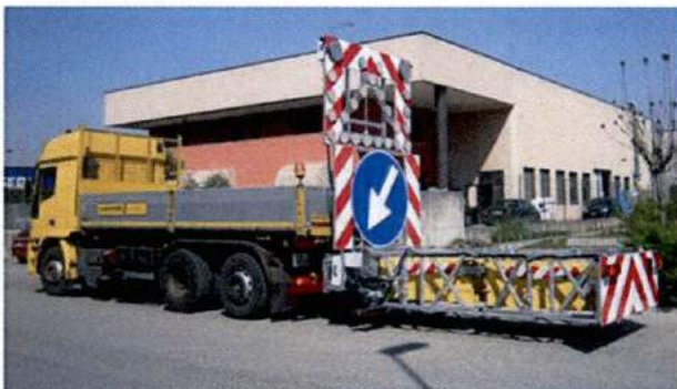
Figura 17: esempio di assorbitore d'urto abbinato al segnale mobile di protezione Fig. II 401 Art.39 Reg.
