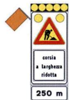
Figura 15: "presegnale di cantiere mobile" derivato dalla fig. Il 399/a Art.39 Reg., da impiegare per lavori sulla sola corsia di emergenza ridotta. E' integrato con set di 5 lampade a led ad alta efficienza luminosa diam. 200 mm (con possibilità di lampeggio sincrono e sequenziale) e con sbandieratore elettromeccanico posto in alto sul lato esposto al traffico.
