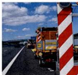
Figura 16: dotazione standard di lampade sul lato dell'autocarro esposto al traffico da utilizzare, ove richiesto dagli schemi, nei cantieri il lento movimento o in lento avanzamento. Il set è composto da 3 lampade a led diametro 200 mm a luce fissa omologate L8H.
