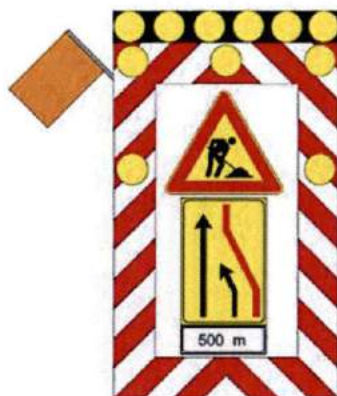
Figura 12: "segnale mobile di preavviso" fig. Il 400 Art.39 Reg. da impiegare su tratti autostradali con corsia di emergenza per la chiusura di una o più corsie di transito (la figura esemplifica la chiusura della corsia di marcia in dx). E' integrato con set di 6 lampade a led ad alta efficienza luminosa diam. 300 mm (con possibilità di lampeggio sincrono e sequenziale) e con sbandieratore elettromeccanico posto in alto sul lato esposto al traffico.
