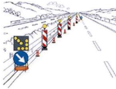
TESTATA DI RIDUZIONE PER CANTIERE TRA 2 E 7 GIORNI
